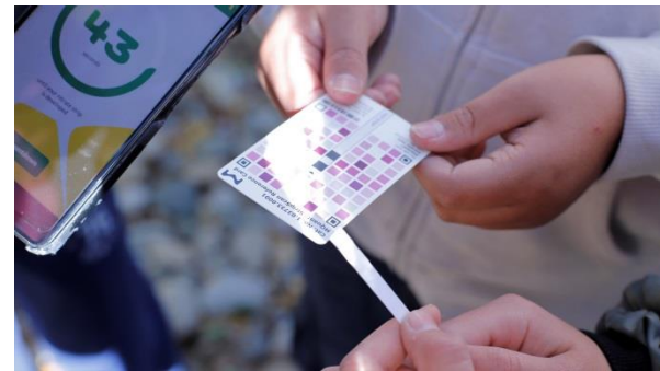
Este es el kit básico para analizar el nivel de nitratos del agua. La información se recogen en una app que centraliza los datos llamada CitMApp
