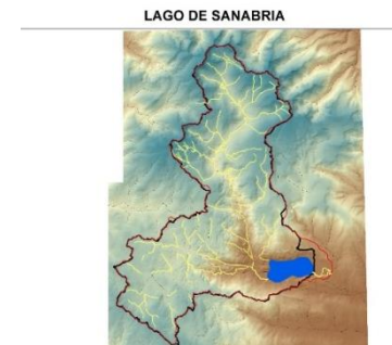
Fig 1. Delimitación cuenca hidrográfica a partir del Modelo Digital del Terreno de alta resolución elaborado con ficheros lidar ( http://www.ign.es )
