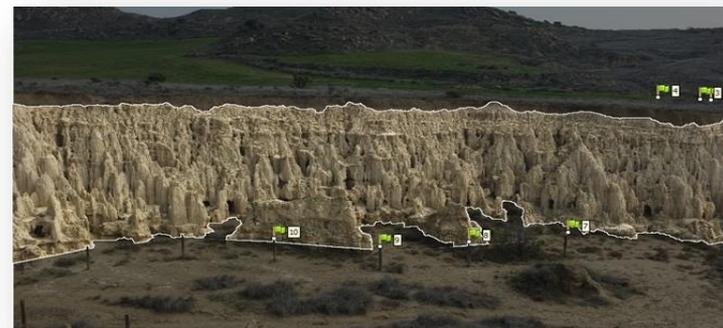
Fig 7. Imagen digital del área de estudio con máscara y puntos de control para el análisis fotogramétrico o (Agisoft Photoscan)
